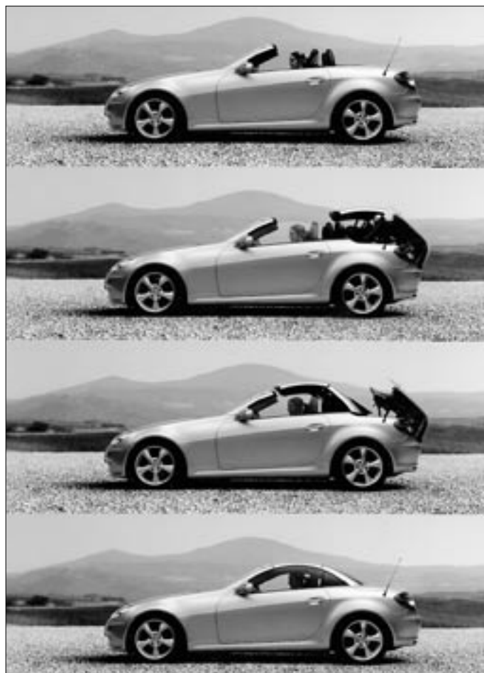
Proměna otevřeného prostoru posádky v uzavřený a naopak se stává stále snadnější a rychlejší. Systém elektrohydraulického ovládání sklopné střechy nachází uplatnění u více výrobců. Na snímcích jsou zachyceny jednotlivé fáze uzavírání střechy u nejnovějšího typu Mercedesu SLK.
