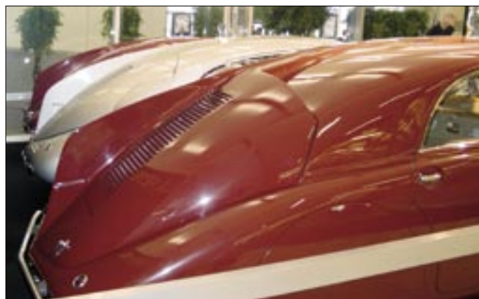
Ojedinělý pohled na zadní kapoty všech tří typů světově uznávaných „aerodynamických“ Tater. Žebrování sloužilo nejen k odvětrání motorového prostoru, ale i k průhledu okénkem dozadu, který sice nemohl být zvláště vynikající, ale během jízdy se také nemohl nijak znečišťovat
