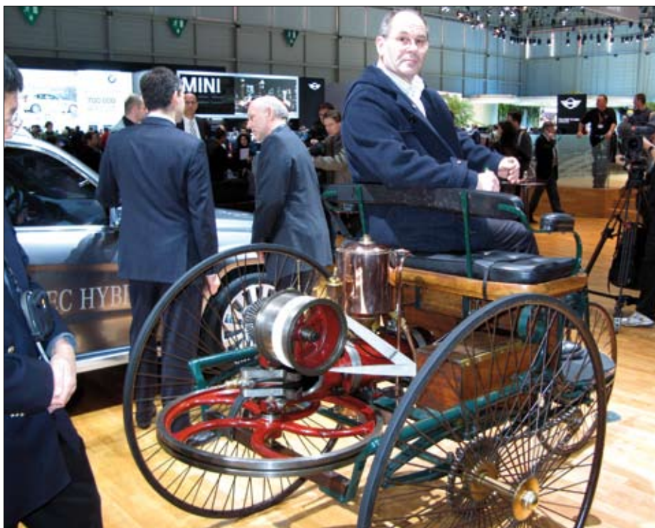
Tříkolový Benz má jednoválcový motor o objemu jeden litr a výkonu 1 k, převod koženým řemenem na předlohu a odtud dvěma řetězy na obě zadní kola
