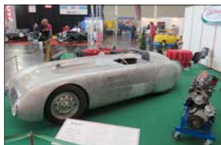
Konstrukce Karla Klinga z roku 1947 stojí na předválečném BMW 328 a díky lehké a aerodynamické karoserii stačilo k závodním úspěchům i 135 koní
