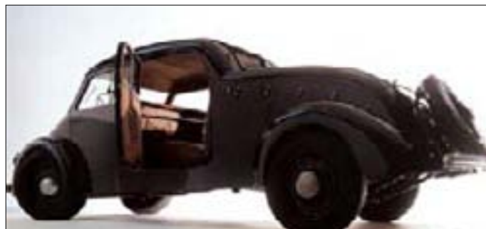
Stela RCA, r. v. 1941, elektromobil; 48 článků dávalo 335 Ah. Jen baterie vážily tunu, auto vydrželo jet cca tři hodiny rychlostí 28 km/h, přičemž max. rychlost byla 50 km/h
