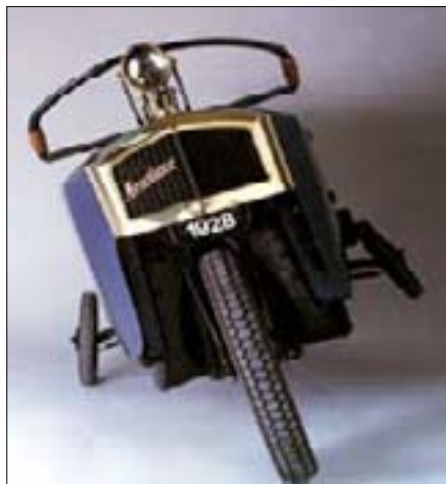
Monotrace, r. v. 1928, podobný německému Mauseru. Zatahovací stabilizátory, které dnes obdivujeme u proudnicových motorek od švýcarského Wagnera, byly vymyšleny již před osmdesáti lety
