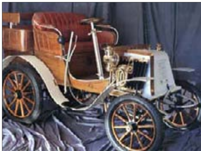
Renault, r. v. 1901, typ D, jednoválcový püllitr, se řtil rychlostí až 40 km/h
