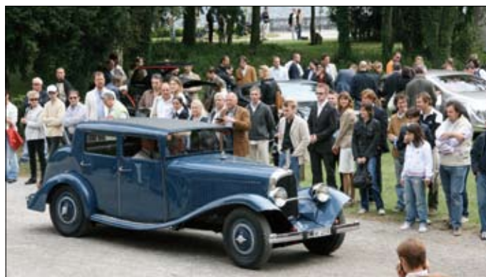
Voisin C 24 (1934) se šoupátkovým šestiválcem o objemu 2994 ccm
