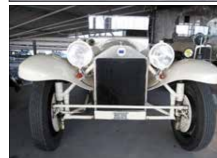
Lancia Lambda, r. 1925, s 2litrovým 4válcovým vidlicovým motorem má velmi pokrokové zavěšení kol
