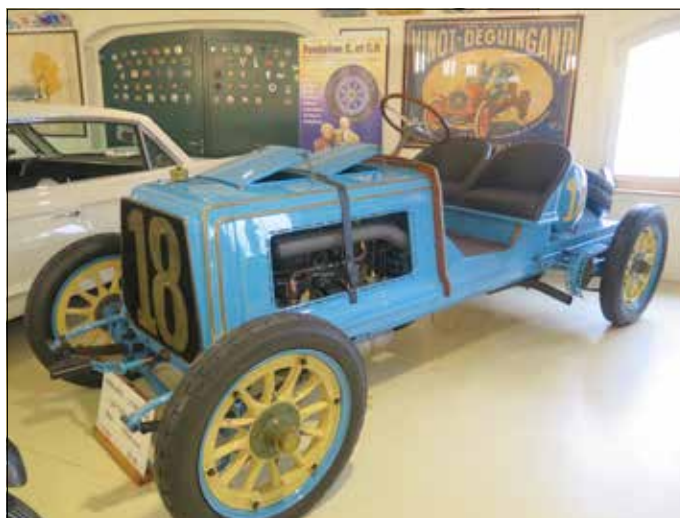
Závodní vůz Panhard Levassor Typ Q, r. 1908 s velkoobsahovým motorem (10,5 l)
