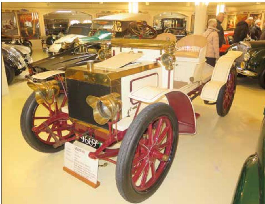
Martini z roku 1903, 4 válce, 4 l, vyjel po kolejišti zubatky na Rocher de Naye přes 2000 m n. m.
