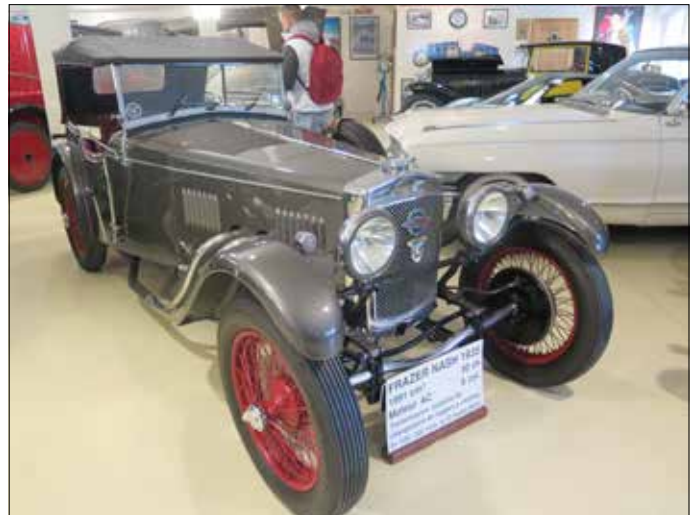
Fraser Nash, s motorem AC byl v r. 1936 držitel rekordu 1000 mil za 22 h 43' – pozoruhodné je řízení rychlostí pomocí řetězů
