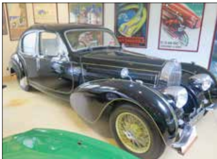
Bugatti 50 S z roku 1931 s mocným kompresorem, který naháněl motor o 8 válcích a 5 l až na 175 km/h
