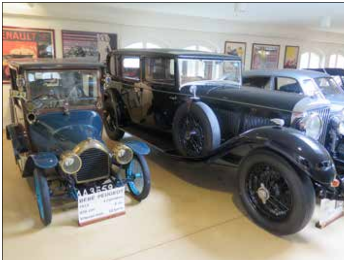
Bebé Peugeot z 1913 – má motor o 860 cm 3 , 6 PS a brzdy jen vzadu – 2x větší, 5x těžší a 40x silnější motor, to je vedlejší Bentley z r. 1930
