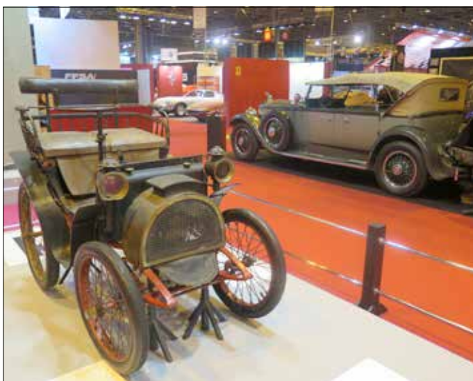
Renault Voiturette CMV, Typ A z roku 1899 – v původním stavu, nikdy nerenovaný, byl prvním vozem vybaveným chlazením vodou (Patent Renault)
