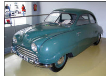
Jeden z prvních dvouválců, typ 92 z roku 1950, 25 PS, 764 ccm
