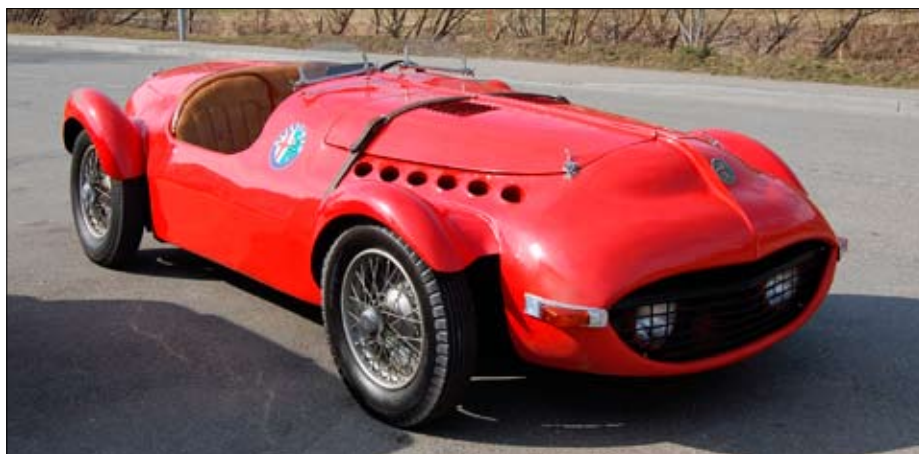
Alfa Romeo 6C 2300 Speciale. Motor 2,3 l, 6 válců, převodovka a chasis renovovány po válce „za železnou oponou“ (blinkery ze Škody 1000MB). Hliníková karoserie, vůz je pojízdný, ale delší dobu nejezdil. Při odhadu 65–75 tisíc prodáno za 75 000 franků
