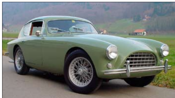
AC Aceca, Bristol r. v. 1959. Řízení na pravé straně, dvoulitr, 6 válců Bristol Motor (jako BMW 327/328). Vyrobeno bylo pouze 169 exemplářů. V roce 2003 kompletně restaurován, veškerá technická dokumentace EU. Odhad sice činil 165–175 tisíc, nabídka pro další jednání je však 125 tisíc franků
