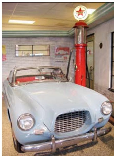
Volvo Sport, laminátový roadster s motorem B 14A vybavený dvojitým karburátorem a výkonem 70 ks – jeden z 67 vyrobených
