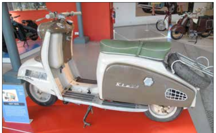
KIEFT R 200, stejný jako Hercules, motor 191 ccm Sachs, 4 rychlosti, el. startér, vyráběl se v letech 1955-56 a stál 216 liber
