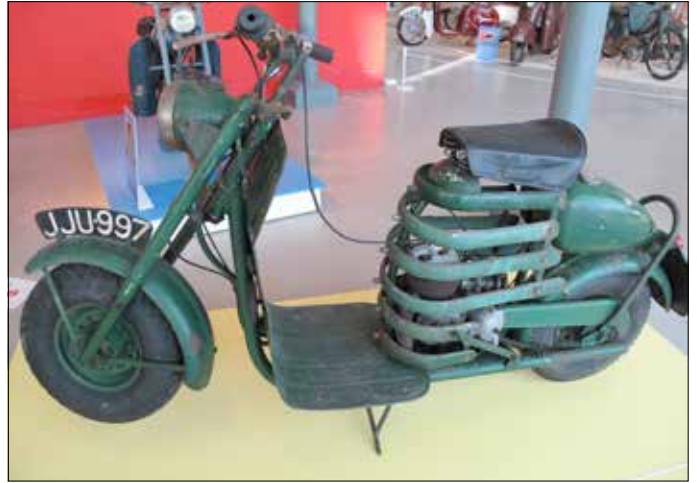
BAC Gazelle. Výrobce: Bond Aircraft 1952/52, motor: 98 a 125 ccm Villiers, malosérie, asi jediný přeživší, stál 94 liber
