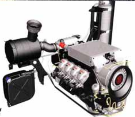
Tatra 163 Jamal s užitečnou hmotností 23/25 t a motorem T3B-928 o výkonu 255, 270 nebo 300 kW
