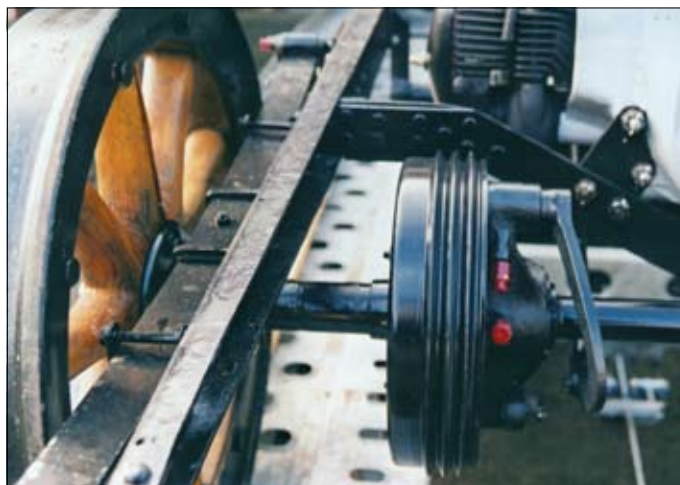
Detail přední nápravy – není řízení, brzda je jen jedna
