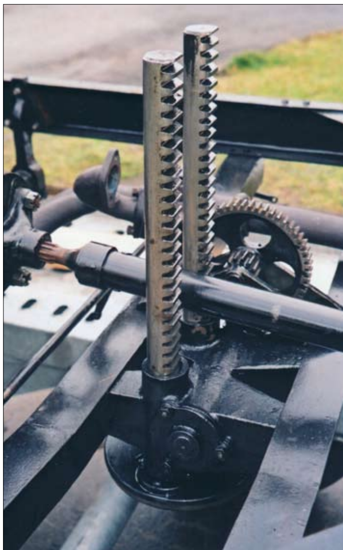
Hlavní vynález drezíny. Téměř neopotřebované dvě ozubené tyče umístěné v těžišti vozidla, ovládané přes pastorek a poháněné ručně pomocí startovací kliky
