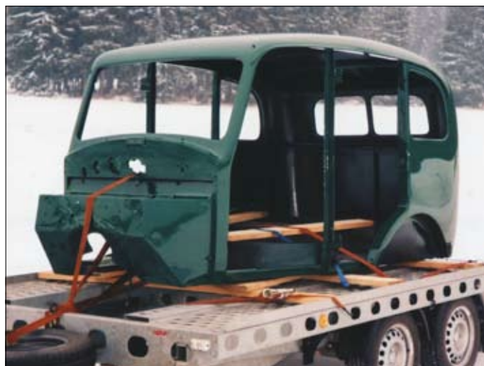
Skelet karoserie po renovaci je převážen k montáži na šasi
