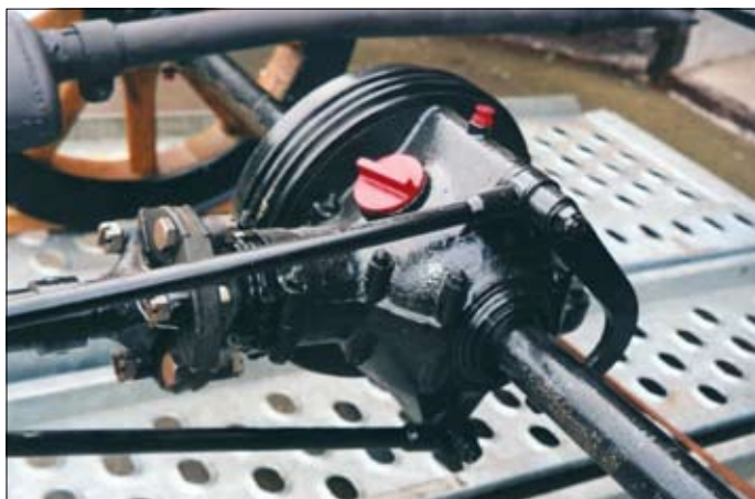
Detail zadní nápravy – není diferenciál, dvě dlouhé tyče zachycují reakci brzdových sil
