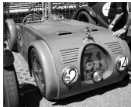
Amilcar zvaný „Tank“ díky jeho revoluční proudnicové nýtované karoserii.
