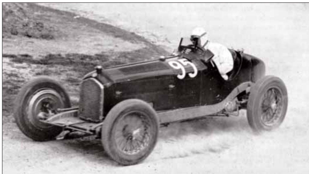
Rudolf Caracciola 1932-ben nyerte meg először a svájci hegyi bajnokságot a 2,6 literes, két kompresszoros Alfa Romeo monoposztóval
