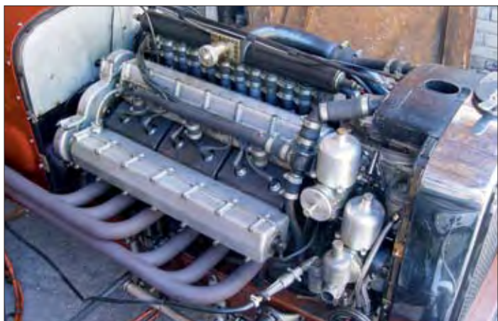
Závodní dvanáctiválec Sunbeam Tigress z roku 1927 patří k speciálním automobilům stavěným v továrně Sunbeam k překonávání rychlostních rekordů. Za povšimnutí stojí způsob plnění pomocí dvou kompresorů. Ve dvacátých letech byly tyto rychlé vozy velmi úspěšné a ustavily celkem pět světových rekordů, poslední se Sunbeamem 1000hp. Tento vůz poháněly dva letecké motory. V roce 1927 se Siru Henrymu Segravovi podařilo na Daytona Beach překonat hranici 200 mil v hodině a dosáhl rychlosti 327,97 km/hod. Na Klausenpass jej řídil Angličan Mark Lowther
