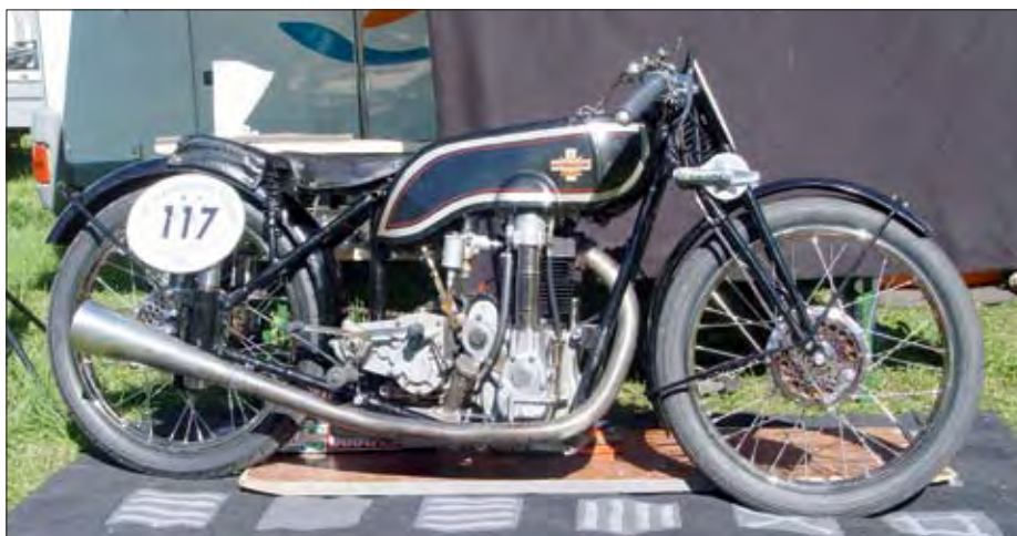
Max Wälti se postavil na start se vzácným motocyklem Motosacoche Typ A 50 z roku 1928, který díky zvláštnímu tvaru nádrže dostal přezdívku „létající banán“. Pětistovka OHC s královským hřídelem je jedním z několika dochovaných kusů. Při nedělním závodě však měl bohužel havárii a odvážel ho vrtulník
