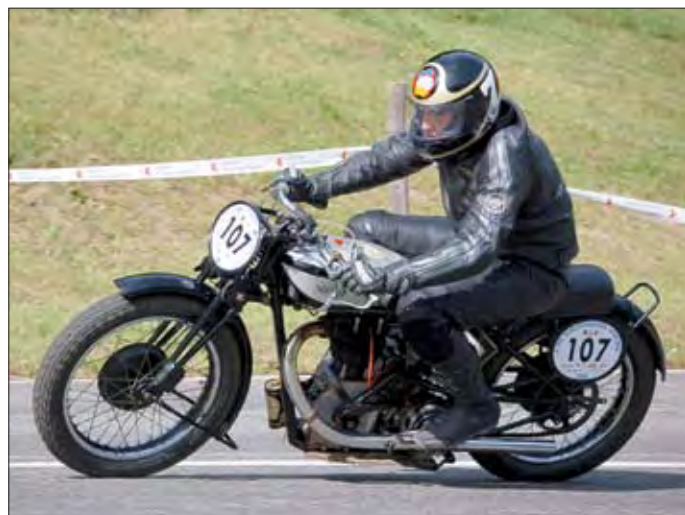
K vidění byly přirozeně i nejúspěšnější závodní motocykly třicátých let – anglické Nortony. S první ze série slavných závodních motorů OHC v motocyklu Norton CS1 startoval Roger Infanger
