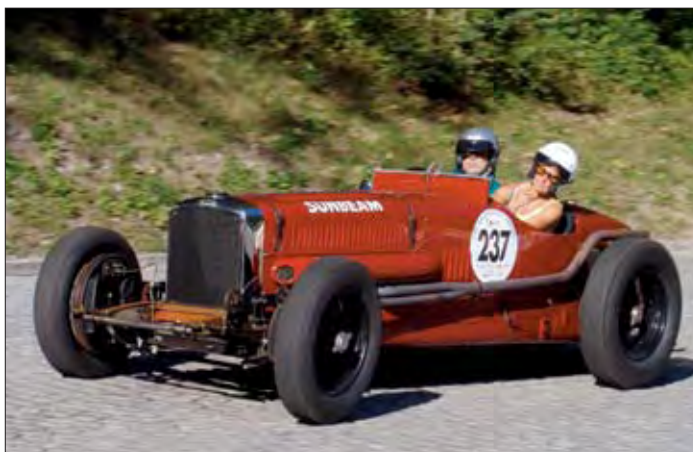
Závodní dvanáctiválec Sunbeam Tigress z roku 1927 patří k speciálním automobilům stavěným v továrně Sunbeam k překonávání rychlostních rekordů. Za povšimnutí stojí způsob plnění pomocí dvou kompresorů. Ve dvacátých letech byly tyto rychlé vozy velmi úspěšné a ustavily celkem pět světových rekordů, poslední se Sunbeamem 1000hp. Tento vůz poháněly dva letecké motory. V roce 1927 se Siru Henrymu Segravovi podařilo na Daytona Beach překonat hranici 200 mil v hodině a dosáhl rychlosti 327,97 km/hod. Na Klausenpass jej řídil Angličan Mark Lowther
